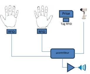
A travers ce projet nous voulons concevoir le système complet à partir de modules élémentaires (lecteurs RFID et tag, microcontrôleur, caméra, amplificateur audio). Les algorithmes de contrôle du système seront implémentés en langage c sous Linux.
