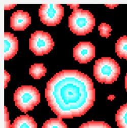
Après seuillage des images on génère la carte des distances de chaque coupe. L'image obtenue permet d'identifier les contours des grains.
