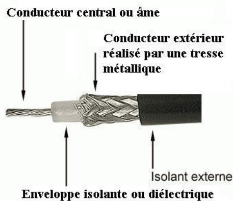
Figure 27 : câble coaxial avec son âme (fil de données) et le blindage (tresse métallique)
