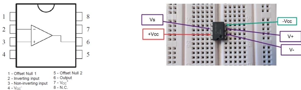
L'alimentation est réalisée à +15V pour +Vcc et -15V pour -Vcc. Je vous rappelle qu'avant de brancher une alimentation, il est obligatoire de la vérifier au voltmètre... **Vous devez rajouter deux condensateurs de 100nF entre la patte Vcc+ et la masse et la patte Vcc- et masse.**
