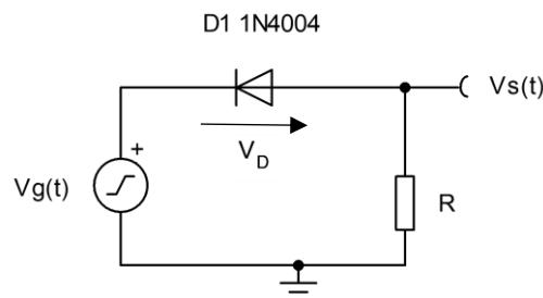
Mesurez et tracez ce courant et cette tension toujours sur deux périodes du signal d'entrée. Analysez le résultat obtenu et comparez-le avec le résultat théorique
