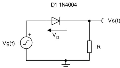
Le signal  $V_g(t)$  est un signal triangulaire entre -5V et 5V, de fréquence 1KHz. La résistance R est une résistance de 1 kOhm.
