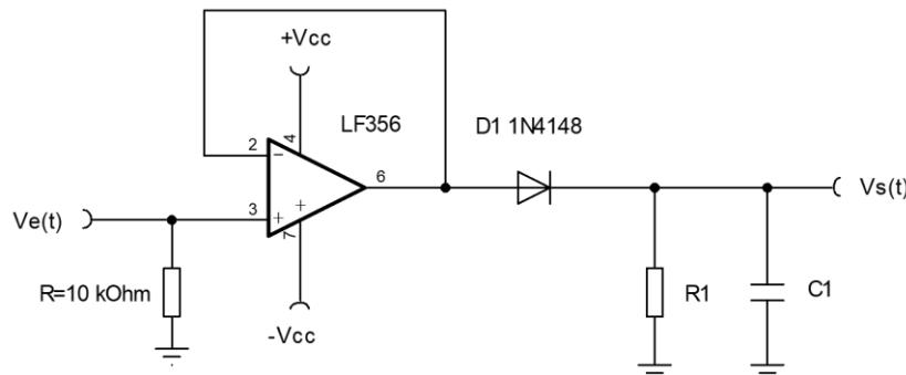
Réalisez le montage en utilisant l'AOP fourni et en reprenant la diode 1N4148.
