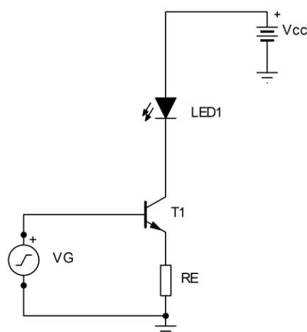
On prendra pour la résistance  $R_e$  une résistance de 270 Ohm. Alimentez le circuit en 5V et mettez en entrée avec le générateur de tension continue que l'on fera varier de 0 à 3V
