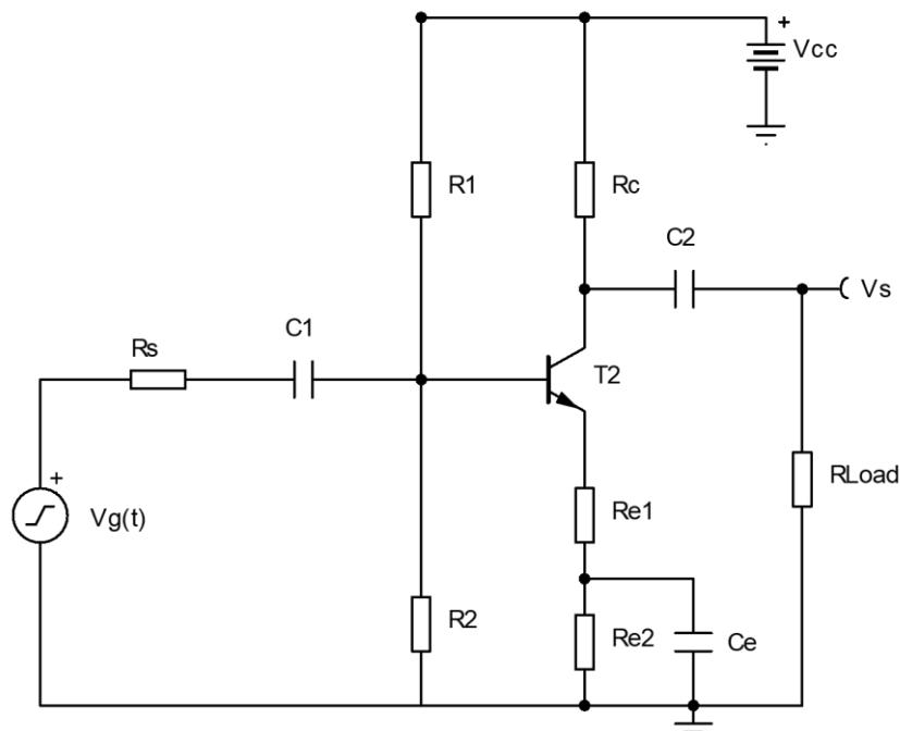
Le montage est polarisé de manière classique, en classe A, avec une tension  $V_{cc}=15V$ . Le courant  $I_{c0}$  est fixé à 2mA et le courant de pont qui circule dans  $R1$  et  $R2$  vaut 0.1mA. La tension  $V_{re2}$  est fixée à
