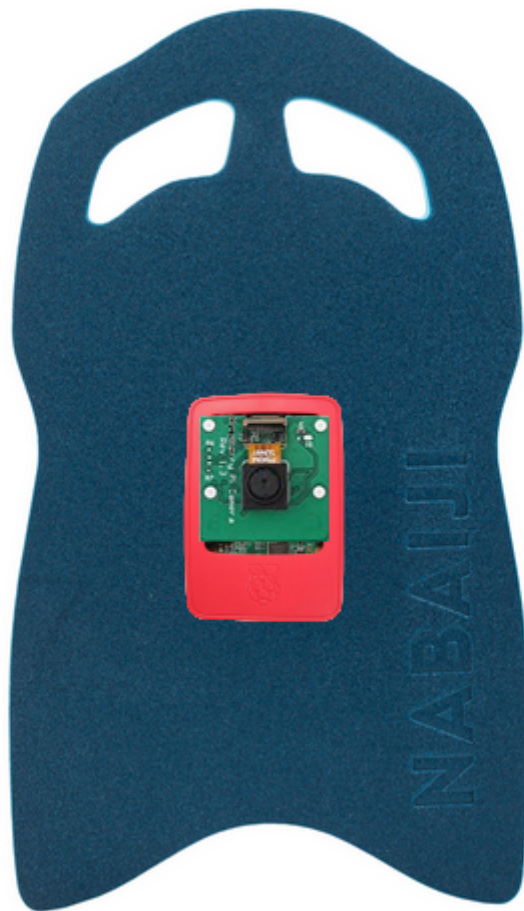
Image 1 : Vue du dessous avec la caméra et le raspberry Pi.
