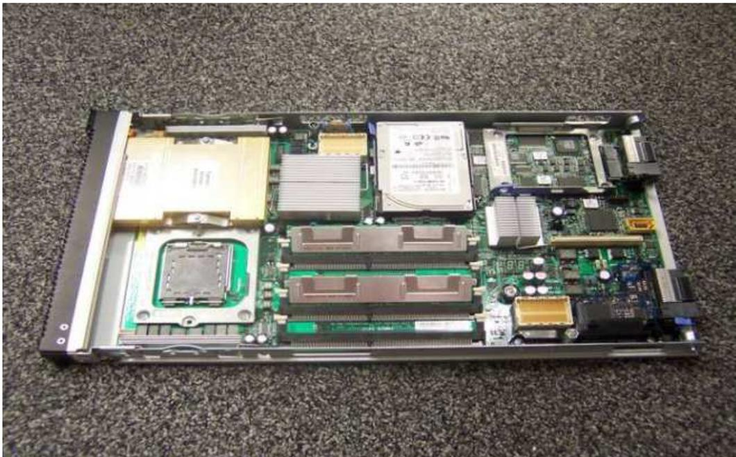
La lame possède 4 slots mémoire en standard et supporte l'ajout d'un module MIO (Memory and I/O Expansion Blade) qui rajoute 2 ports réseau au 2 disponibles de base ainsi qu'un slot d'extension PCI.
