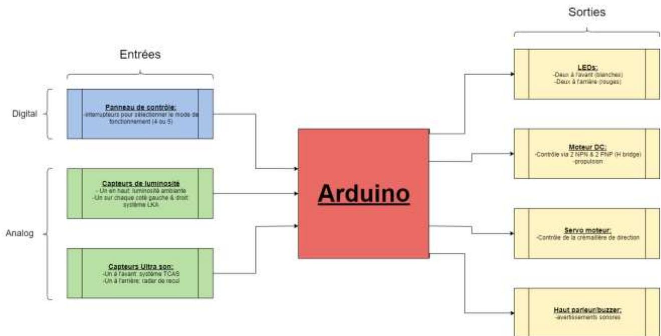
Fig1: représentation schématique de l'architecture système
