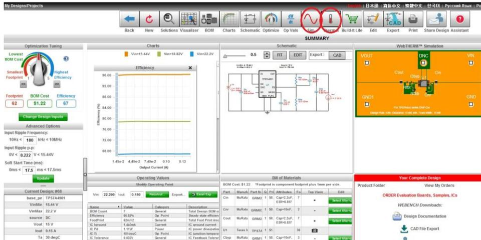
Ouvrir le Design. Cliquer alors sur le schéma et sur l'onglet de la sinusoïde pour démarrer la simulation. Choisir une simulation du type *Steady State* et démarrer la simulation. Cliquer sur le schéma pour faire apparaître la courbe du courant de sortie.
