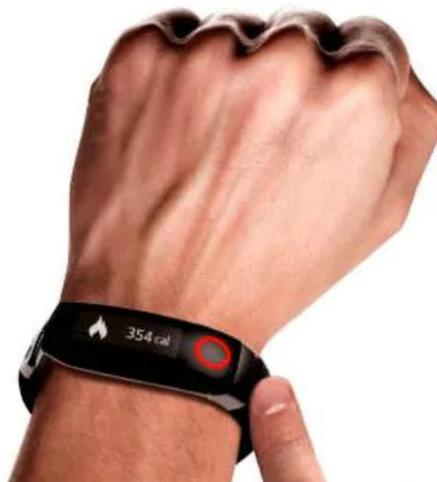
**TRAVAIL À RÉALISER :** l'objectif est de réaliser un bracelet portable permettant de mesurer le rythme cardiaque, le taux de saturation en oxygène et le nombre de pas parcouru par une personne. Le développement de l'électronique est facilité par l'utilisation du système programmable PSOC5 [2] qui permet de définir l'électronique de traitement par software avec le logiciel Cypress PSOC Creator. Les données sont transmises par bluetooth et affichées sur un téléphone portable.
